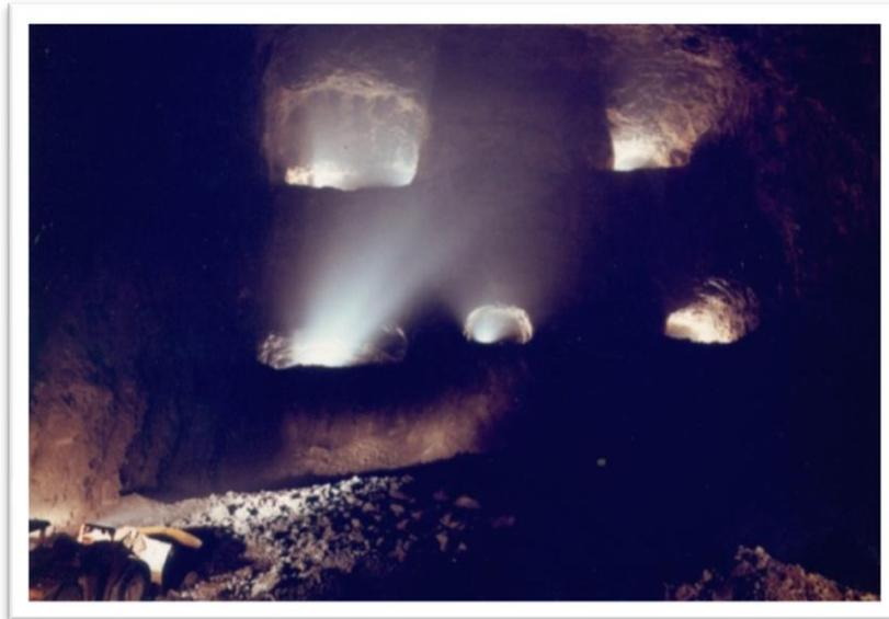
La figura 26 es la fotografía de una cámara en explotación. Desde las galerías iluminadas se realizaban voladuras de grandes bancos, semejantes a los de la corta. En estas cámaras, de 18 m. de ancho por 100 de altura, el riesgo de desprendimiento de rocas era elevado y, por ello, las cargadoras que entraban para sacar el mineral, estaban dirigidas a distancia, por un operador situado fuera de la cámara.
