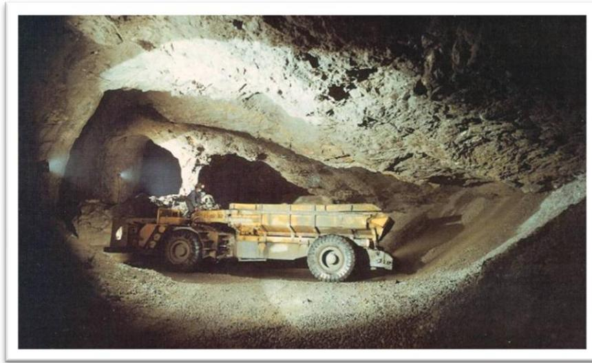
A medida que se iban recuperando los pilares se rellenaba con hormigón el hueco que quedaba. Véase al fondo un pilar a medio recuperar.
