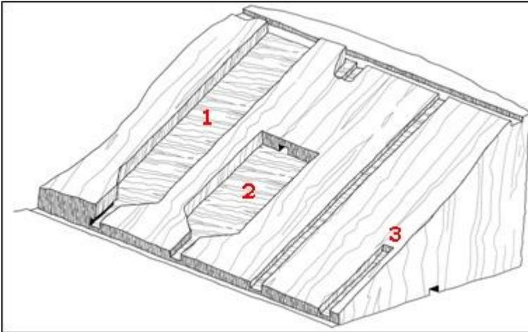
**Fig. n° 22- Croquis de la explotación por cámaras y pilares.**
