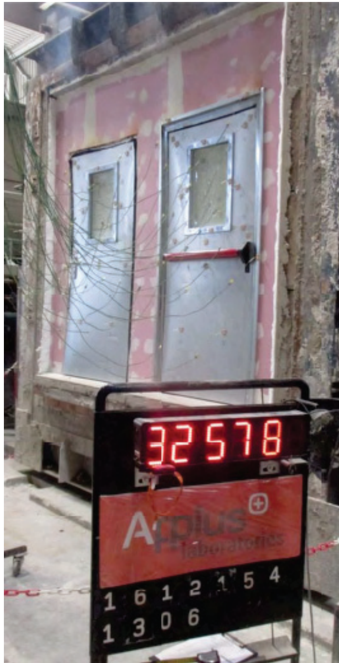
Figura 8-21. Ensayo de fuego 1 hoja. Estado de la muestra transcurridos los 30 minutos de ensayo
