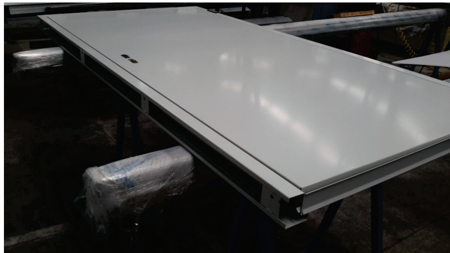
Figura 6-14. Apariencia de un prototipo a escala real lacado en el horno
