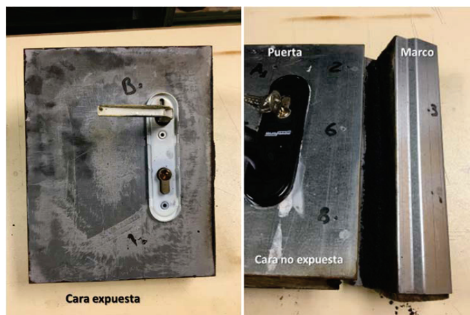
Figura 5-78. Test nº7: detalle de ambas caras tras el ensayo
