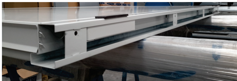
Figura 6-18. Apariencia definitiva de las fijaciones a obra
