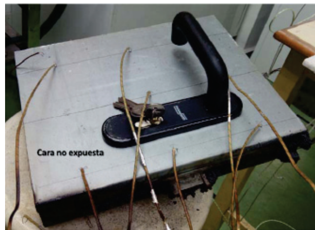
Figura 5-70. Test nº5: detalle de la cara no expuesta de la muestra una vez concluido el ensayo
