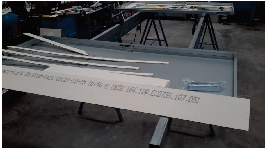
Figura 6-7. Bandeja y aislamiento en el prototipo a escala real
