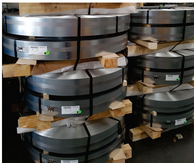
Figura 3-5. Bobina de chapa con el desarrollo adecuado para la obtención del marco por perfilado
