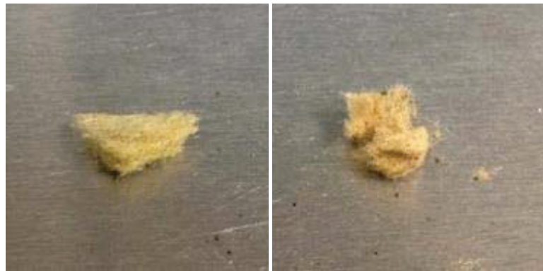
Figura 5-5. Muestra de lana de roca ensayada con referencia Knauf: antes (izda) y después (dcha)
