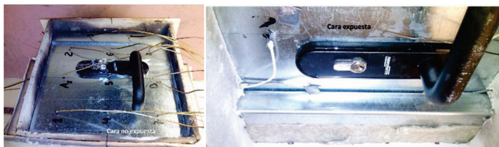
Figura 5-71. Sección preparada para el test nº7. Manilla vista en el exterior de la muestra
