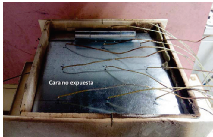
Figura 5-51. Test n°6: muestra preparada para el ensayo con los termopares preparados sobre su cara no expuesta
