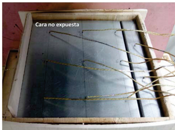
Figura 5-41. Test nº4: muestra preparada en la estructura de ensayo, con los termopares situados en la cara no expuesta
