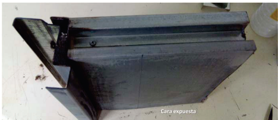
Figura 5-55. Test nº6: estado de la muestra (hoja y marco) una vez finalizado en ensayo
