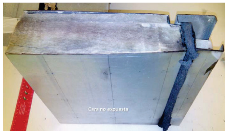
Figura 5-45. Test nº4: estado de la muestra (hoja y marco) una vez concluido el ensayo
