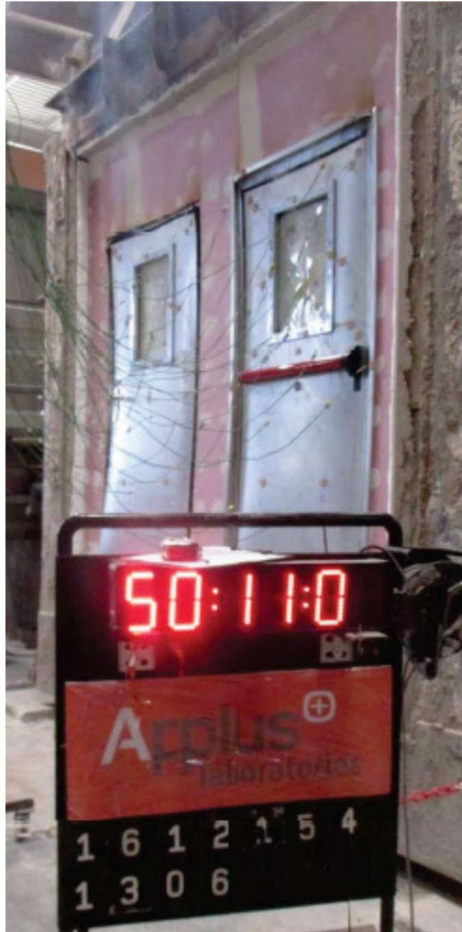
Figura 8-22. Ensayo de fuego 1 hoja. Estado de la muestra transcurridos los 50 minutos de ensayo
