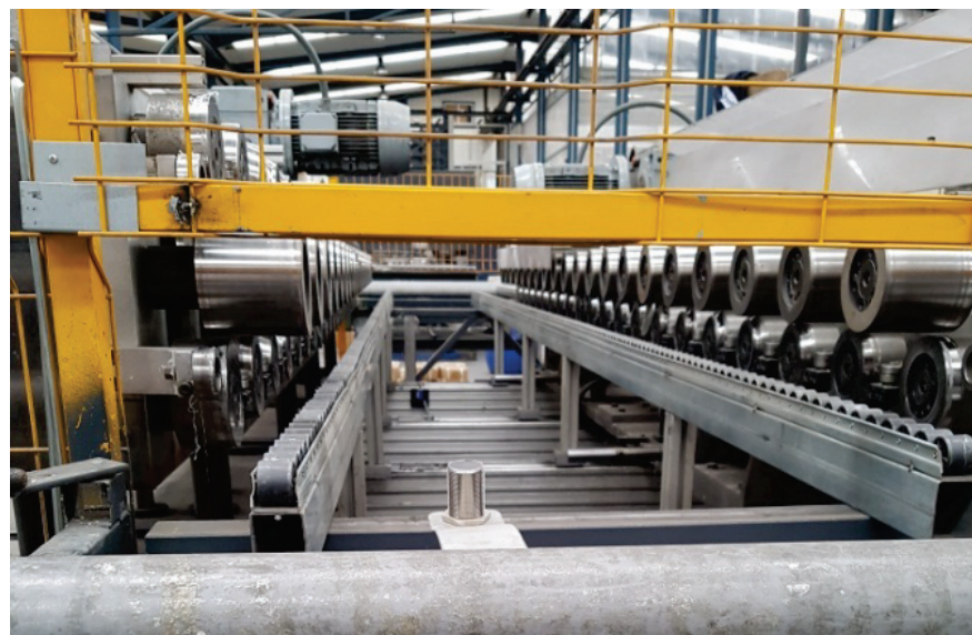
Figura 3-3. Estación de perfilado de las hojas
