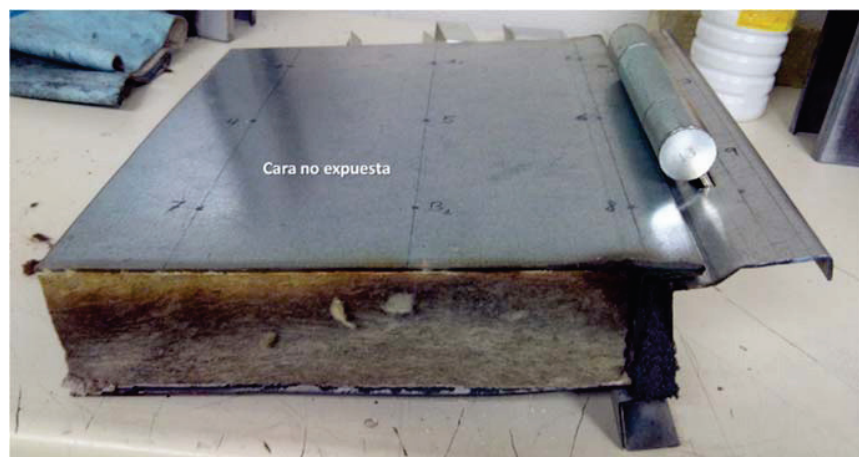
Figura 5-54. Test nº6: estado del material aislante tras el ensayo
