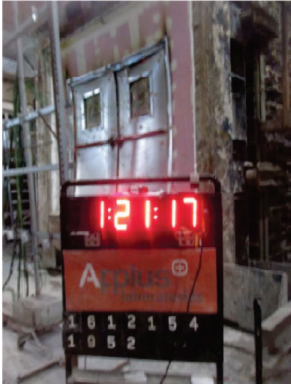
Figura 8-51. Ensayo de fuego 2 hojas. Estado de la muestra superados los 81 minutos de ensayo
