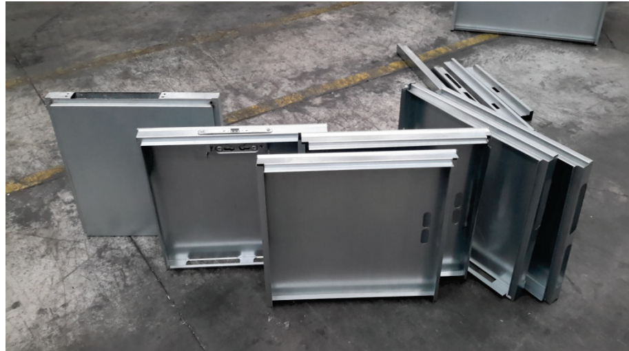
Figura 6-4. Prueba de distintas bandejas metálicas a pequeña escala
