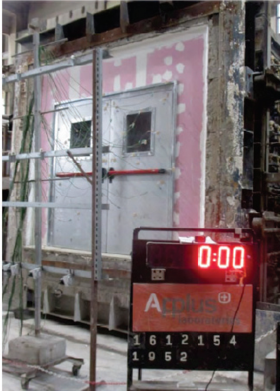
Figura 8-46. Ensayo de fuego 2 hojas. Estado de la muestra en los instantes previos al ensayo
