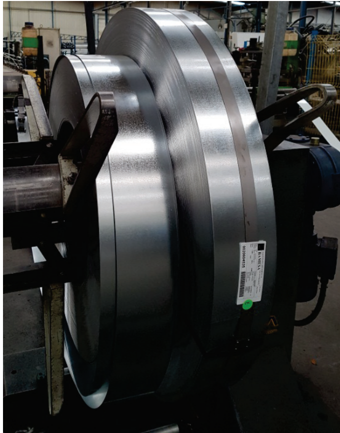
Figura 3-6. Devanadora instalada para alimentar la línea perfiladora de marcos
