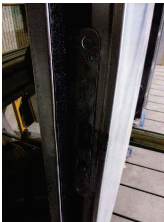
Figura 8-60. Ensayo de durabilidad. Detalle de la zona de contracerradura (hoja pasiva)
