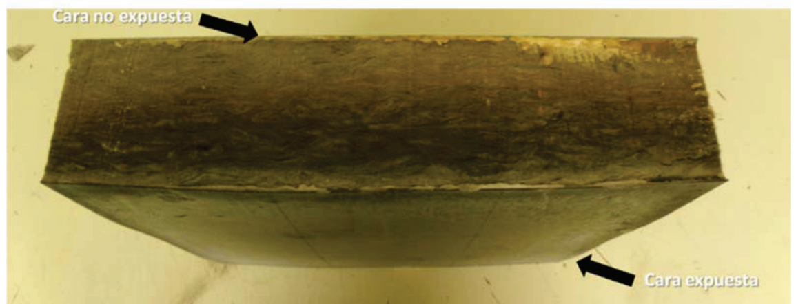
Figura 5-22. Test nº2: estado de la lana de roca una vez finalizado el ensayo
