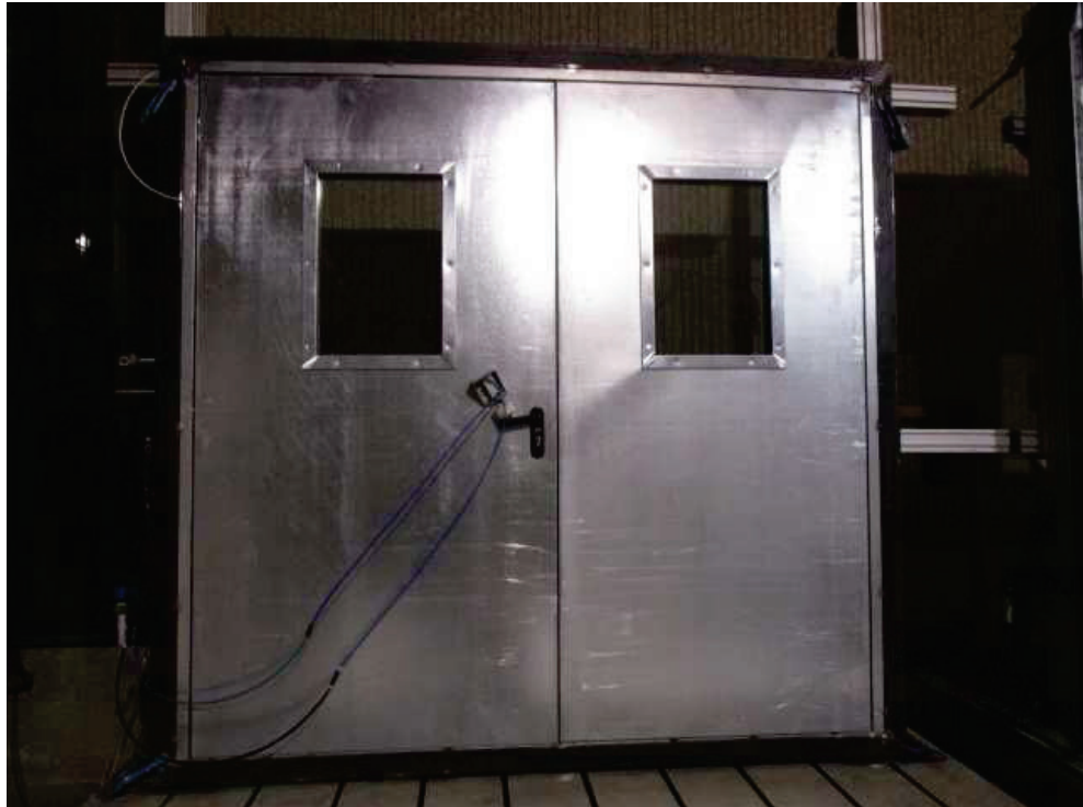
Figura 8-54. Ensayo de durabilidad. Estado de la muestra en el instante previo al ensayo
