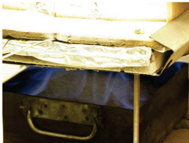
Figura 5-20. Test n°2: detalle de la bandeja de combustible durante el ensayo
