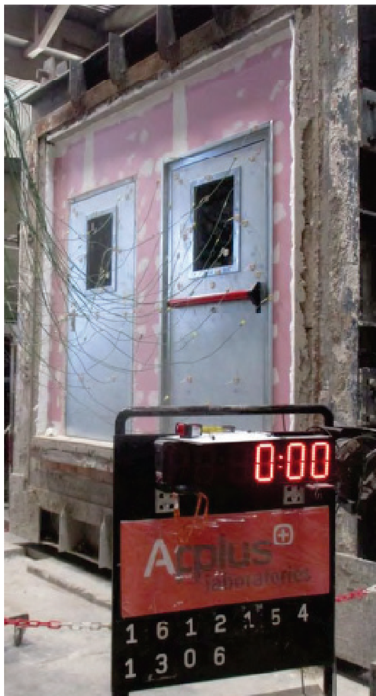
Figura 8-20. Ensayo de fuego 1 hoja. Estado de la muestra en los instantes previos al ensayo
