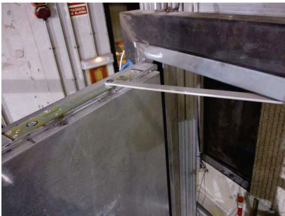
Figura 8-55. Ensayo de durabilidad. Detalle del sistema cierrapuertas oculto
