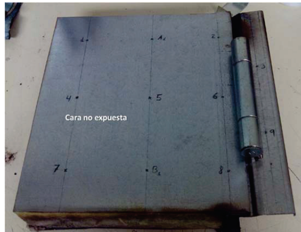
Figura 5-53. Test nº6: estado de la cara no expuesta de la muestra tras el ensayo
