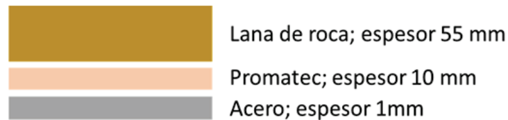
Figura 5-32. Sección ensayada en FDS: material aislante a base de lana de roca y placa de silicato Promatect-H
