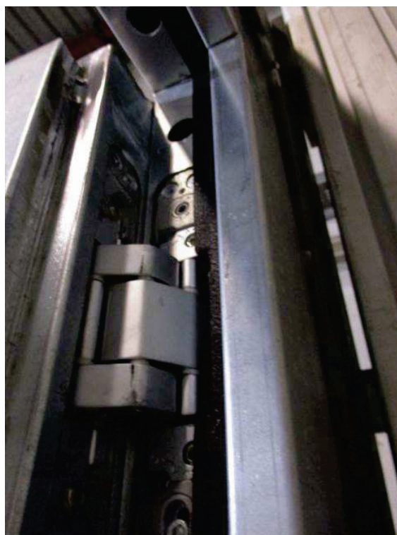
Figura 8-56. Ensayo de durabilidad. Detalle de la bisagra oculta
