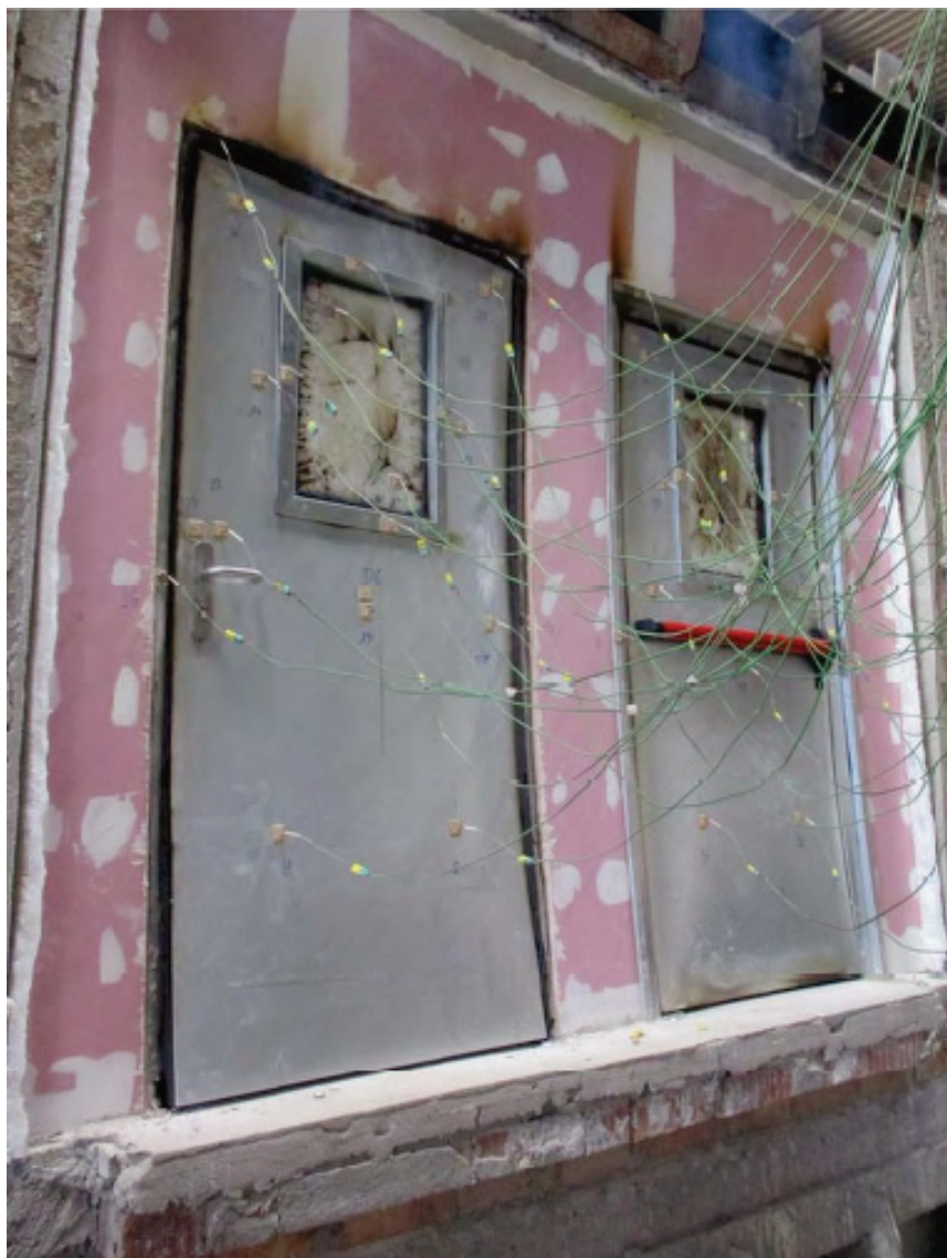
Figura 8-24. Ensayo de fuego 1 hoja. Estado de la muestra una vez finalizado el ensayo
