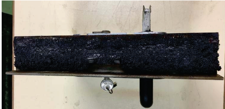
Figura 5-79. Test nº7: Detalle de la junta intumescente una vez finalizado el ensayo
