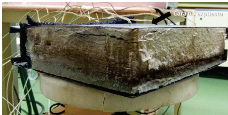
Figura 5-44. Test nº4: estado del material aislante tras el ensayo
