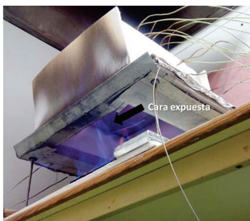
Figura 5-42. Test nº4: vista de la cara expuesta de la muestra durante el ensayo
