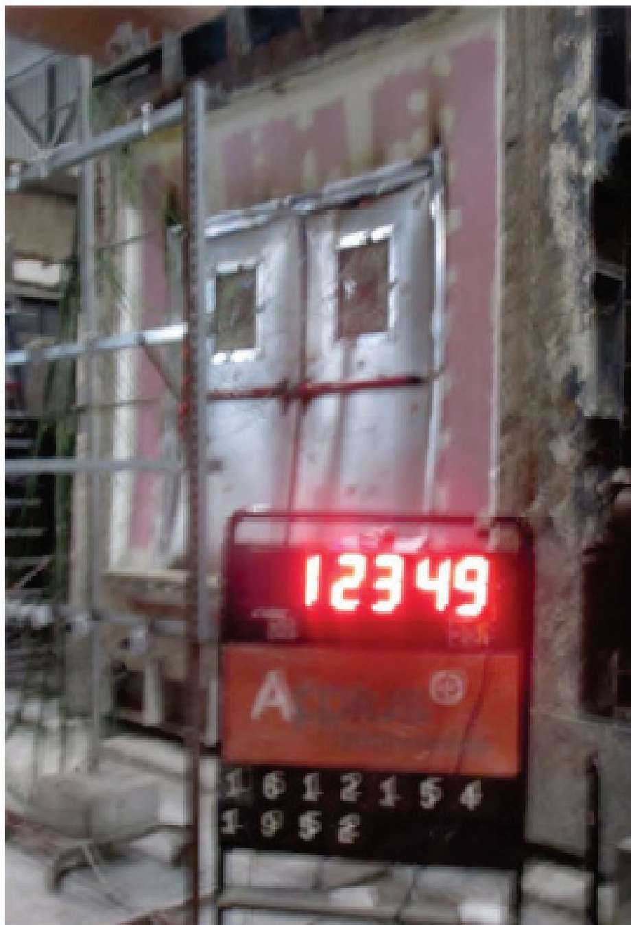
Figura 8-52. Ensayo de fuego 2 hojas. Estado de la muestra una vez finalizado el ensayo
