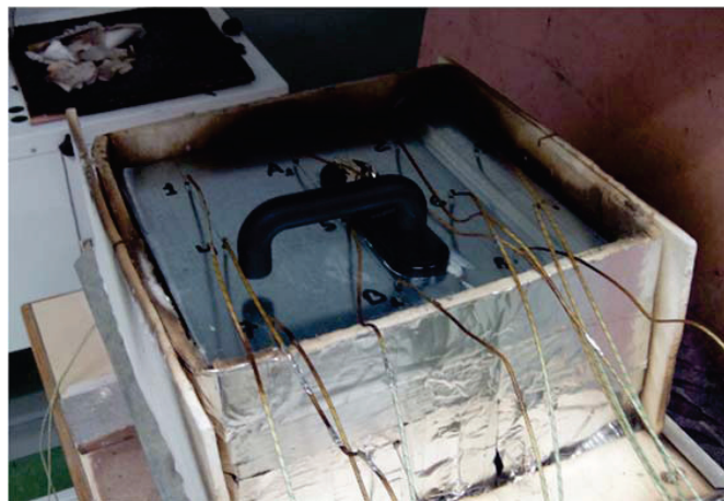
Figura 5-77. Test nº7: detalle de la cara no expuesta tras el ensayo
