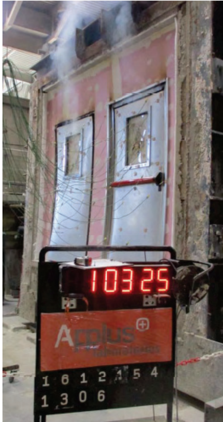
Figura 8-23. Ensayo de fuego 1 hoja. Estado de la muestra transcurridos los 60 minutos de ensayo
