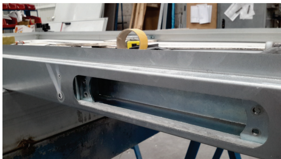
Figura 6-9. Preparación de las bisagras en el prototipo a escala real
