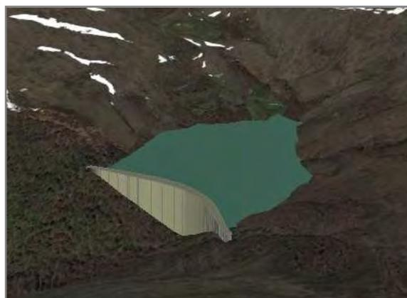
**Ilustración 28: Modelo 3D del embalse superior (1Hm3). Elaboración propia.**
