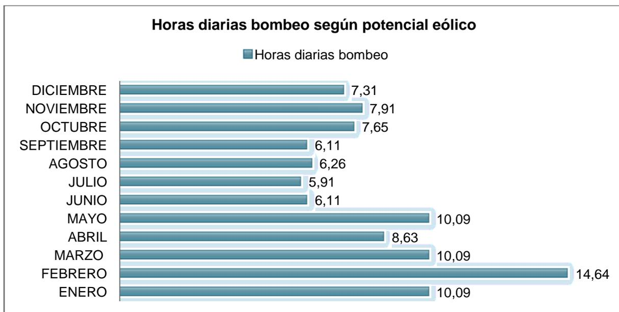
Ilustración 22: Horas diarias de bombeo según potencial eólico. Elaboración propia.
