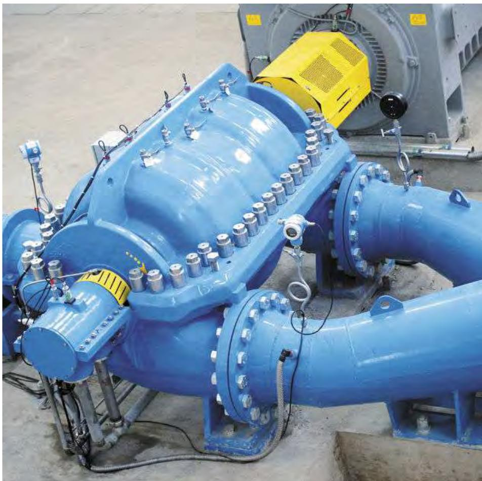
Ilustración 2: Bomba multietapa carcasa partida axialmente. FUENTE: Andritz Hydro.
