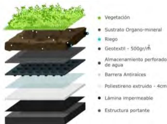
Ilustración 2: Sistema de cubierta vegetal<sup>1</sup>.
