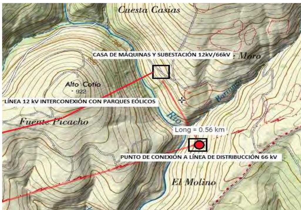
**Ilustración 31: Esquema de las líneas proyectadas: (12kV interconexión parques eólicos) y (66 kV de subestación a punto de conexión) y existentes: (66 kV distribución).**
