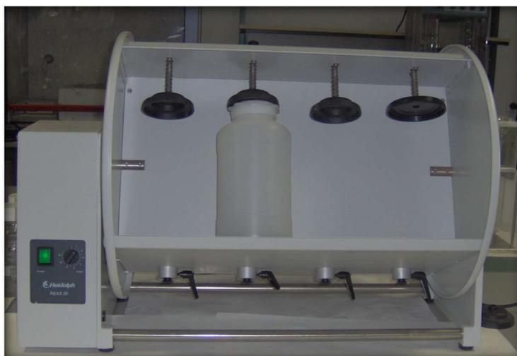
*Imagen 3.2. Agitador rotativo modelo REAX 20 de Heidolph para la prueba de lixiviación del residuo.*
