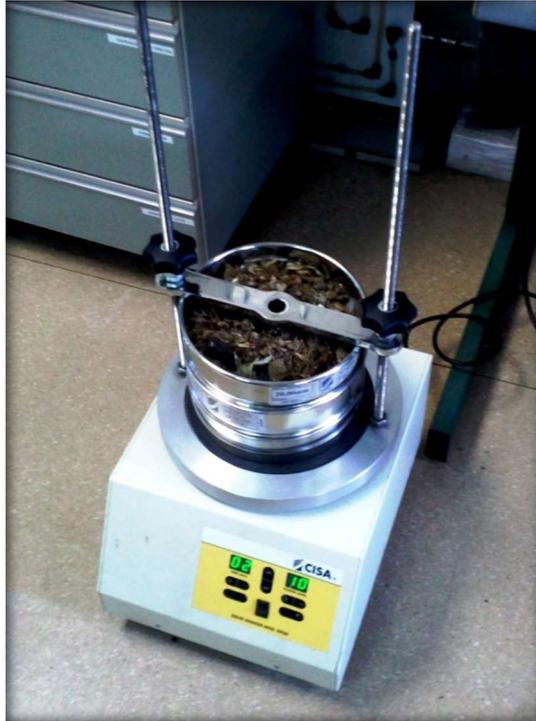
Imagen 3.1. Tamiz vibratorio utilizado para la separación por tamaños.
