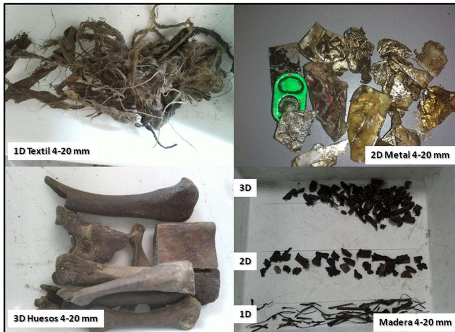
Imagen 4.4. Clasificación según forma de algunos componentes de la fracción entre 4 y 20 mm del rechazo RR<sub>Can</sub>.
