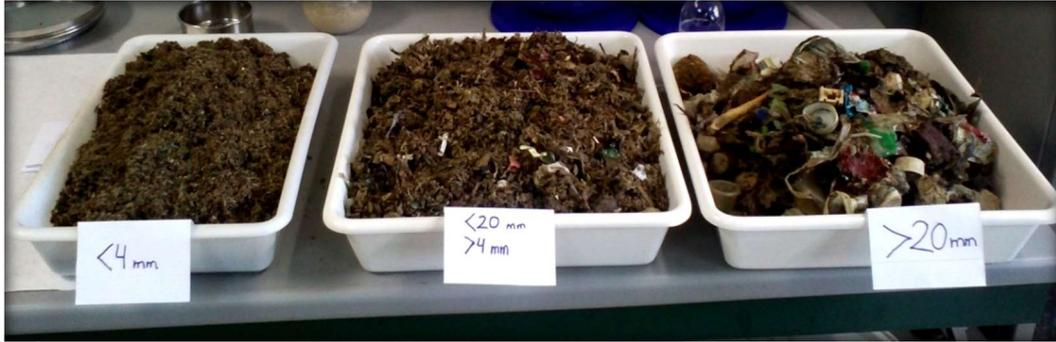
Imagen 4.1. Separación por tamaños de la muestra de rechazo de recirculación de Barcelona ( $R_{recBar}$ ).
