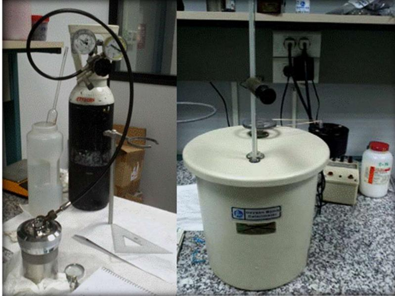
Imagen 4.5. Calorímetro utilizado en la medida del poder calorífico.
