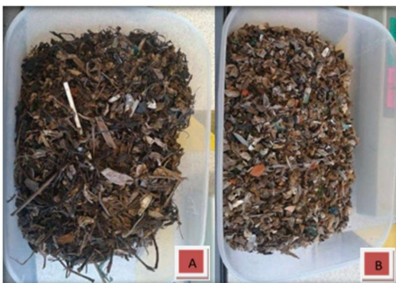
Imagen 5.2. Fotografías del residuo menor de 8 mm (A) utilizado en las columnas A y B y del residuo recortado (B) utilizado en las columnas C y D.
