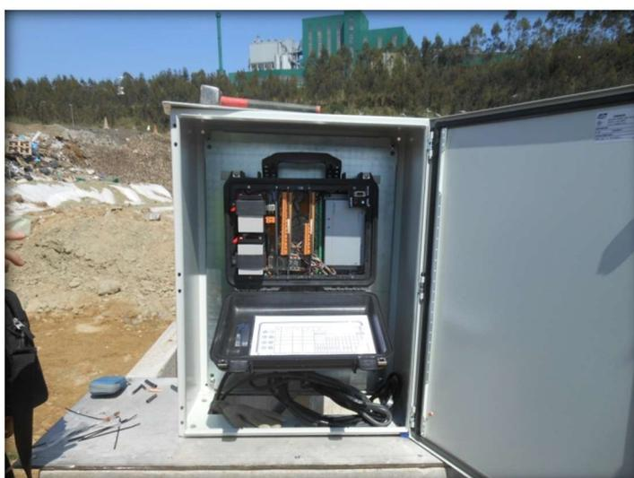
Imagen 6.7. Panel con data logger para el seguimiento de la medida de PT100 y piezómetros.
