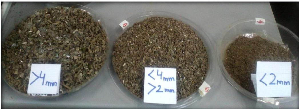
Imagen 4.2. Separación por tamaños de la muestra de rechazo por separación densimétrica de Barcelona ( $R_{ArBar}$ ).
