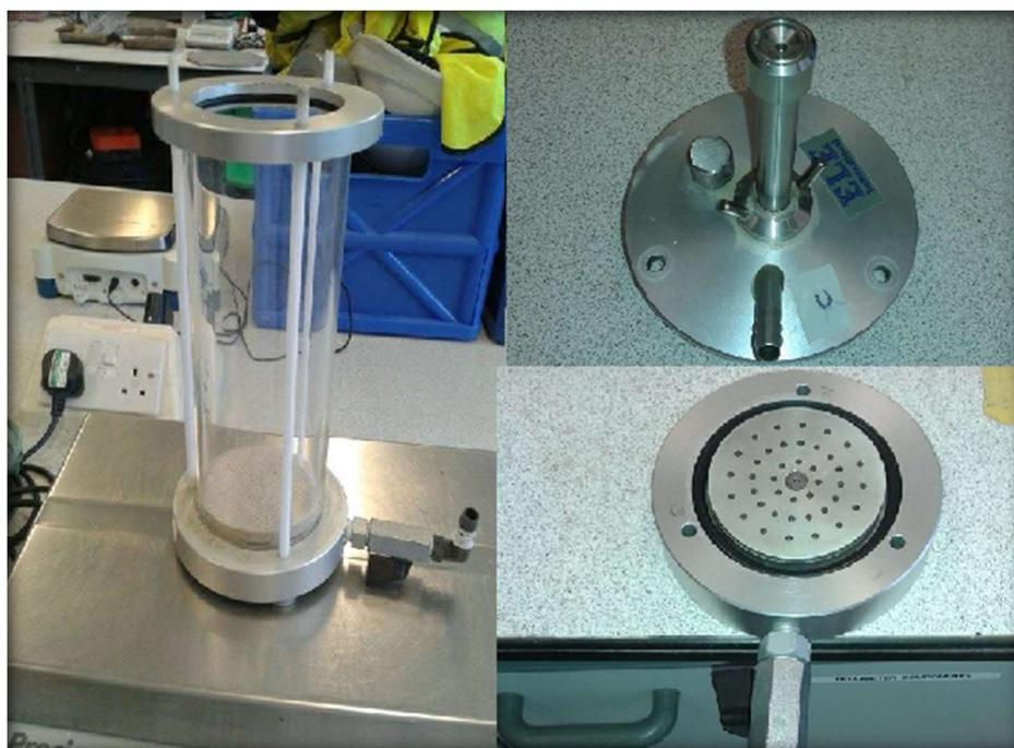
*Imagen 5.1. Detalle del cuerpo y las tapas superior e inferior de una de las columnas pequeñas utilizadas en los ensayos de Inglaterra.*
