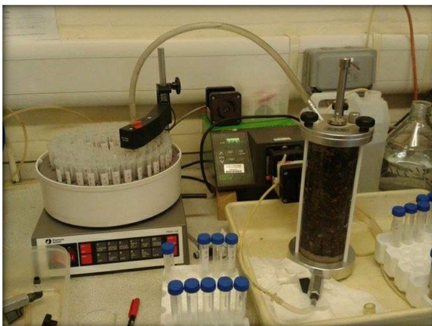
Imagen 5.4. Sistema de recolección de muestras durante el ensayo de lavado de contaminantes en columnas pequeñas.
