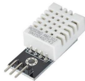
Figura 3.5. SENSOR DHT22
