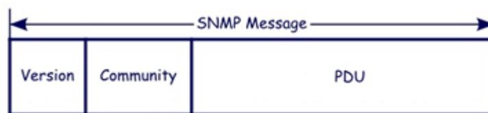
**Figura 2.3. Estructura Mensaje SNMP**
