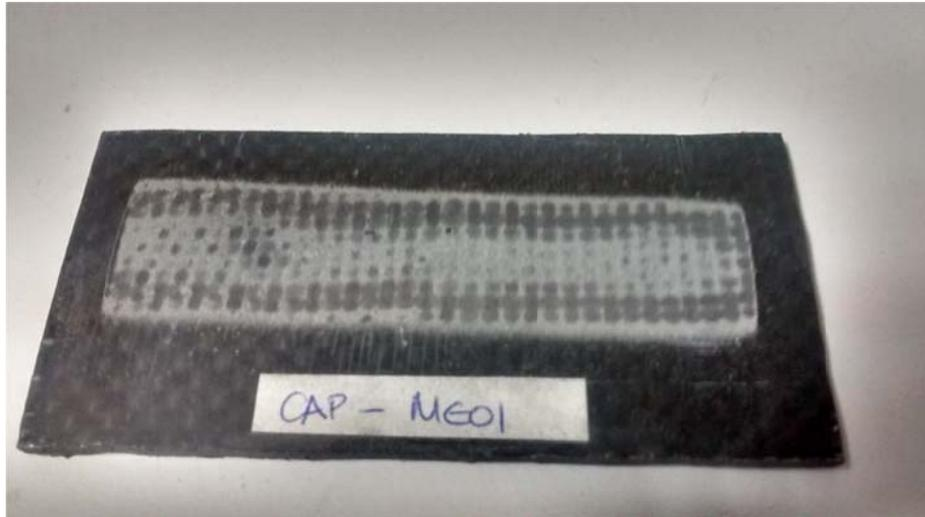
*Fig. 3.23 Probeta utilizada para el ensayo de erosión (véase la huella).*
