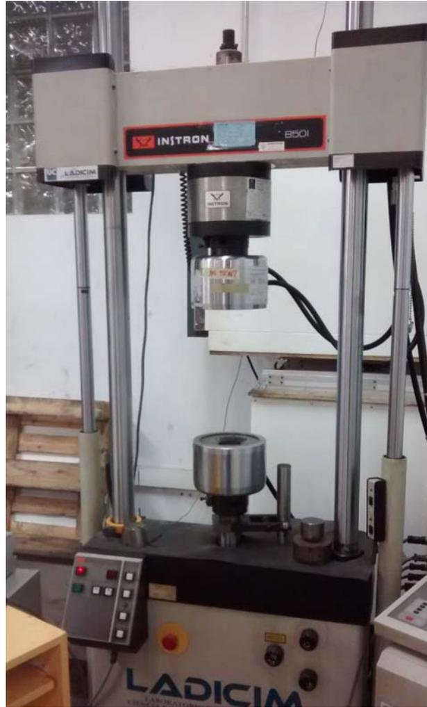
*Fig. 3.8 Máquina de ensayos Instron 8501 utilizada para realizar el ensayo de tracción.*
