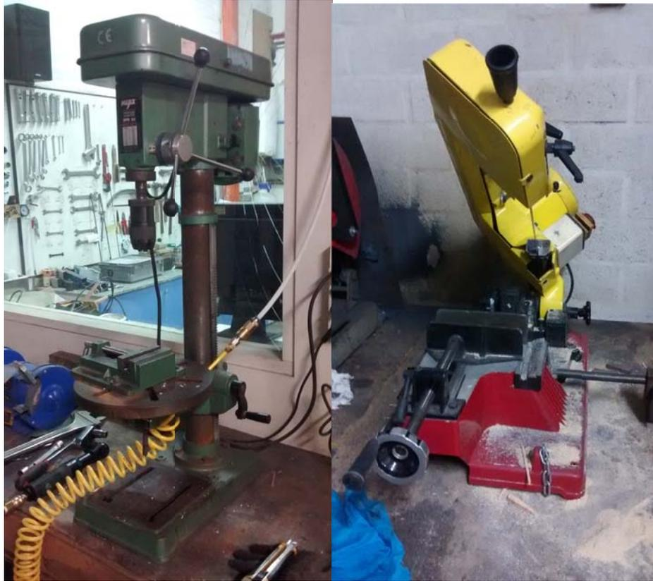
*Fig. 3.6 Taladro de columna (derecha) y sierra de cinta semiautomática (izquierda)*
