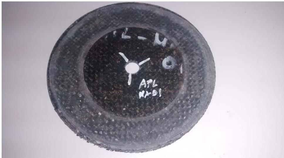
Fig. 3.15 *Probeta utilizada para el ensayo de abrasión o ensayo normalizado Taber (ya ensayada).*
