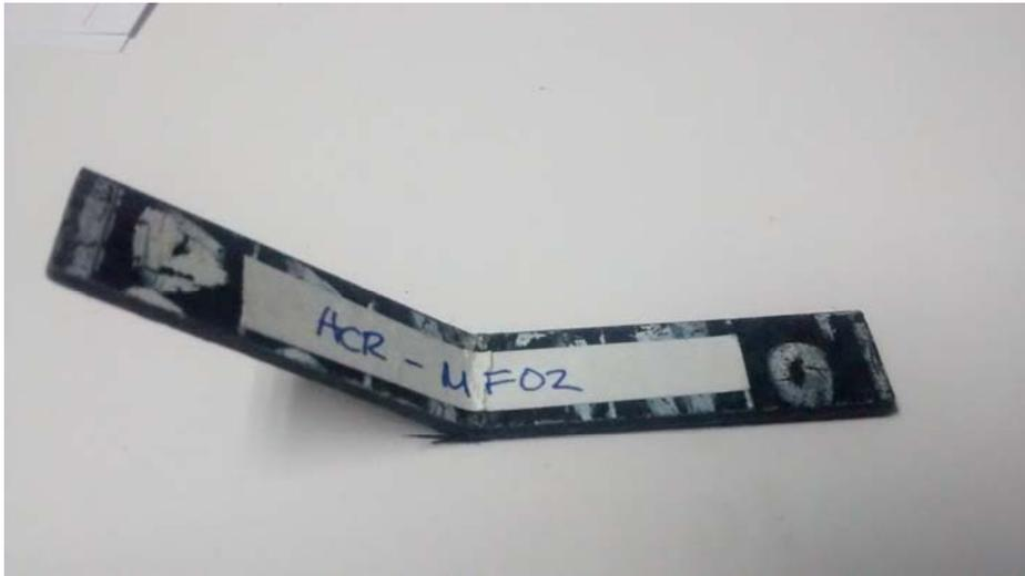
Fig. 3.10 Probeta del ensayo de flexión en tres puntos (ya ensayada).
