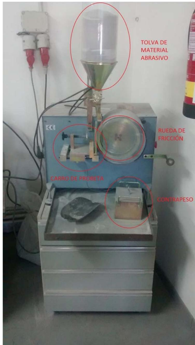
Fig. 3.24 Máquina utilizada para conducir el ensayo de erosión.
