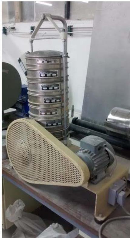
*Fig. 3.2 Máquina agitadora con una serie de tamices montados.*
