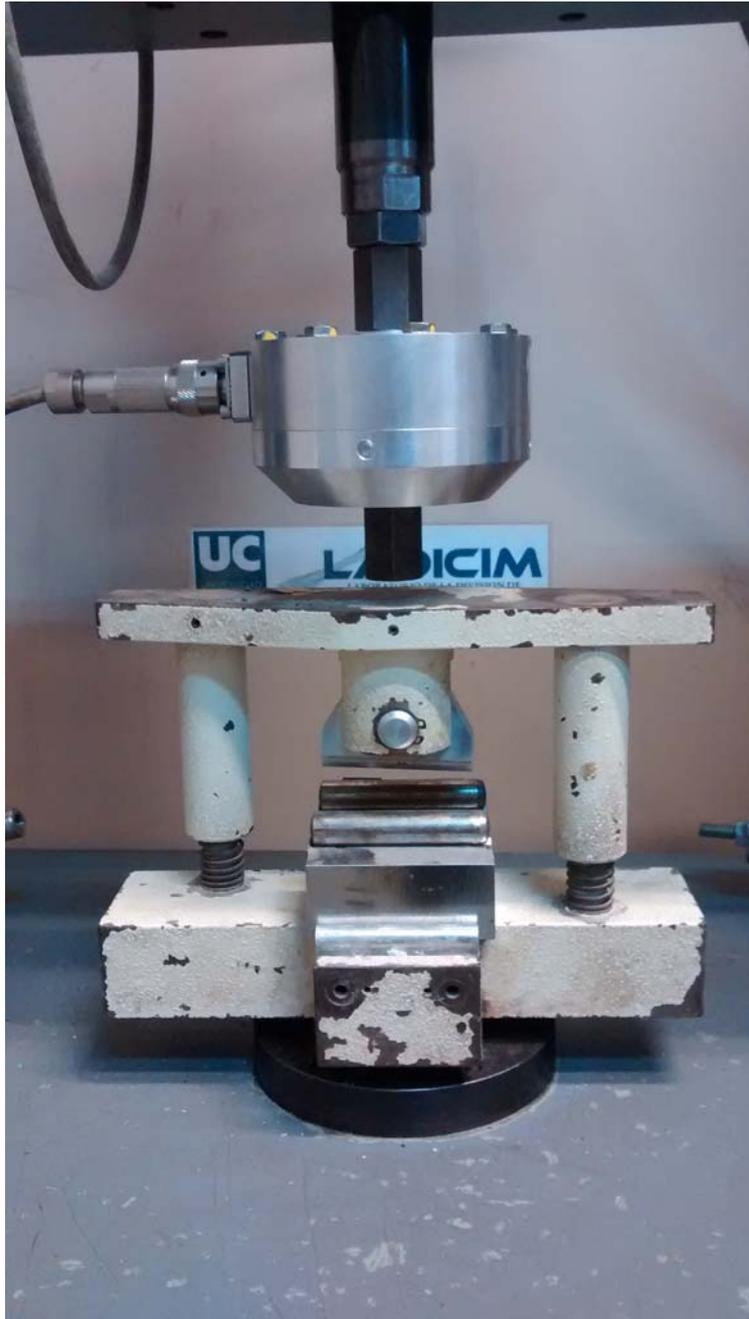
*Fig. 3.11 Máquina de ensayos Servosis Serie Me-405 utilizada para realizar el ensayo de flexión en tres puntos.*
