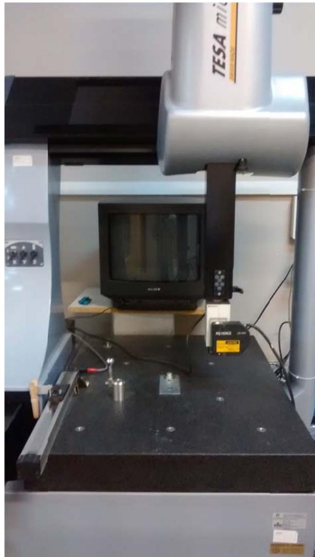
*Fig. 3.27 Montaje de la probeta sobre el carro de la máquina.*
