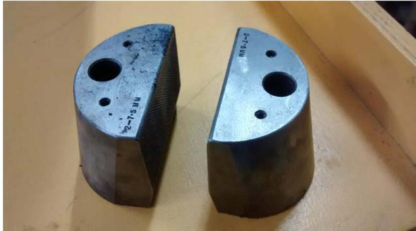
*Fig. 3.9 Mordazas seleccionadas para realizar el ensayo de tracción (para probetas de 2 a 7.5 mm de espesor).*
