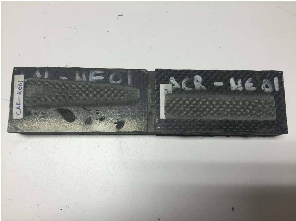
*Fig. 3.25 Cuatro probetas de erosión montadas en su correspondiente bastidor.*
