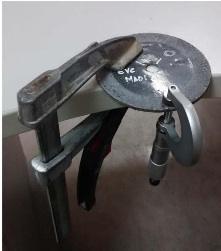
*Fig. 3.21 Medida del espesor de una probeta de abrasión durante un ensayo.*
