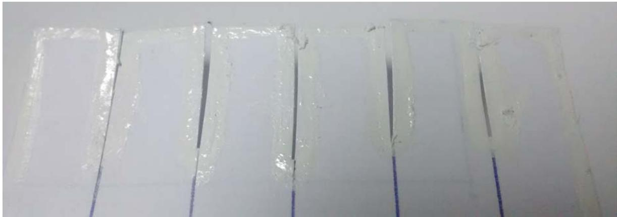
Fig. 3.7 Plantilla para realizar el dibujo de las probetas de tracción, Charpy y flexión.
