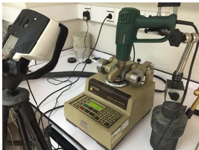
*Fig. 3.22 Montaje final de la decapadora (verde) y de la cámara termográfica.*
