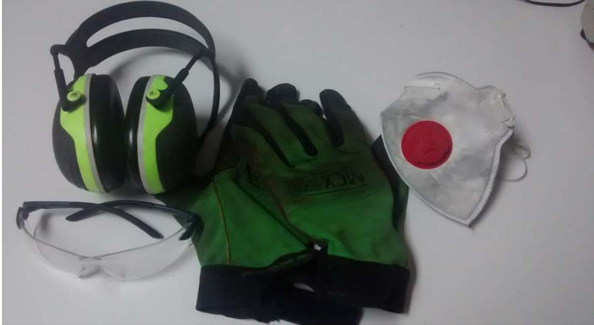
*Fig. 3.1 Equipo de seguridad completo (guantes, mascarilla, gafas protectoras y cascos de insonorización).*
