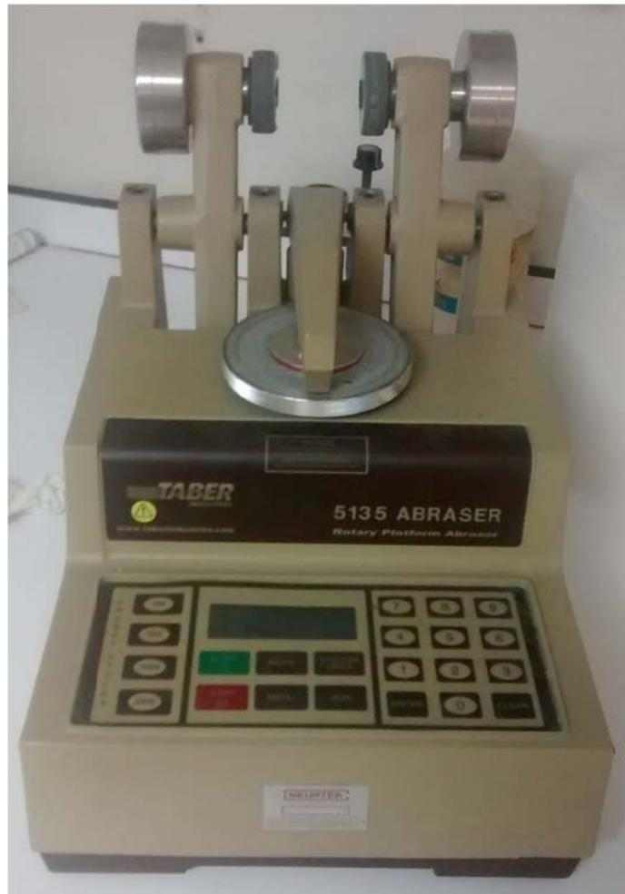
*Fig. 3.16 Abrasímetro Modelo 5135 de Taber Industries utilizado para el ensayo de abrasión.*
