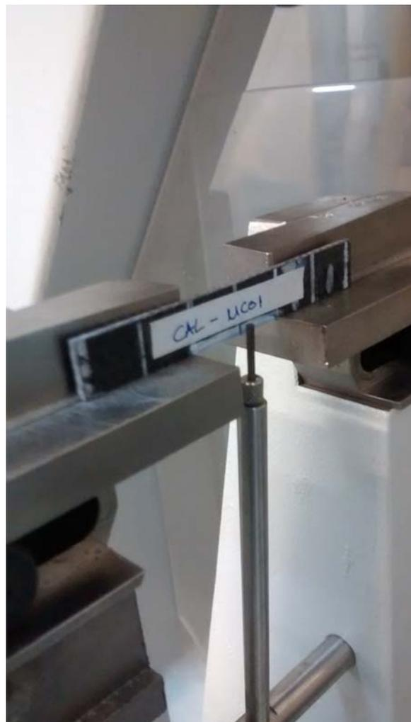
*Fig. 3.14 Elemento auxiliar para centrar la probeta Charpy entre los apoyos.*
