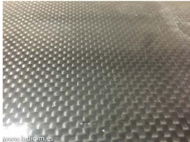
*Fig 2.1.2 El material conocido como “fibra de carbono” pertenece a la clase de materiales compuestos reforzados con fibra. En la figura se puede apreciar el tejido entramado de fibras de carbono embebido en una matriz polimérica de epoxy.*
