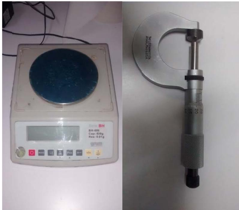
*Fig. 3.19 Báscula utilizada para la medida de peso de las probetas (izquierda) y micrómetro utilizado para la medida de espesores de las probetas (derecha).*
