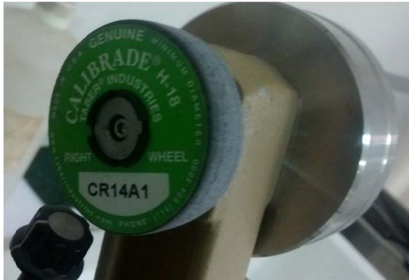
*Fig. 3.17 Muela Calibrade H-18 montada en el abrasímetro Taber utilizado en los ensayos del proyecto.*
