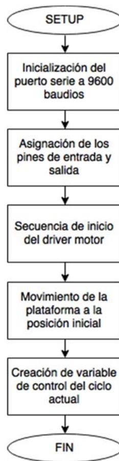
Figura 8. Diagrama de flujo referente al procedimiento de 'Setup' del programa de control de Arduino
