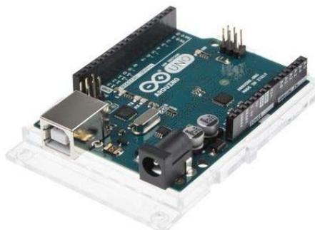
Figura 13. Placa microcontroladora Arduino Uno
