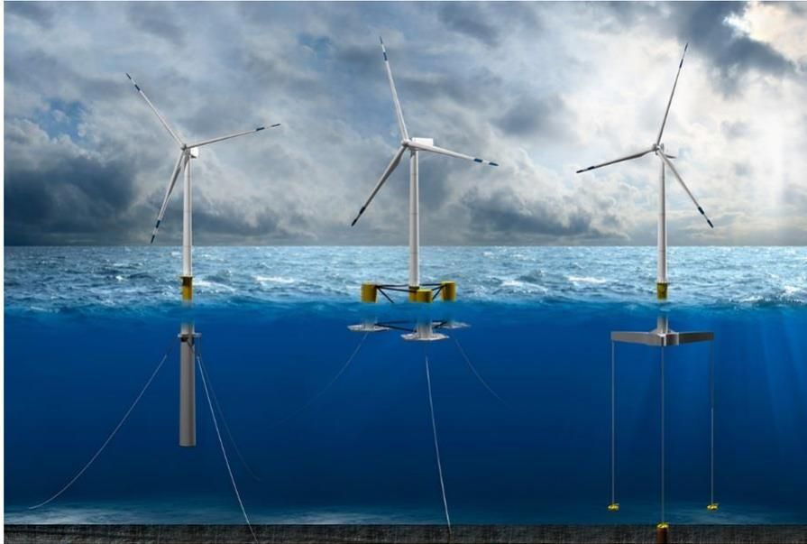
*Figura 2: Conceptos de turbinas eólicas flotantes.*
