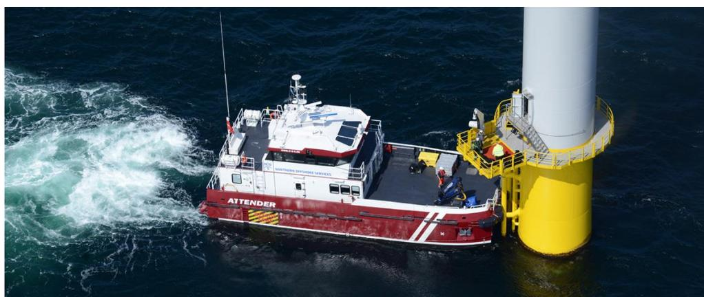
Figura 5: Concepto “walk-to-work”: acceso por medio de una defensa.
