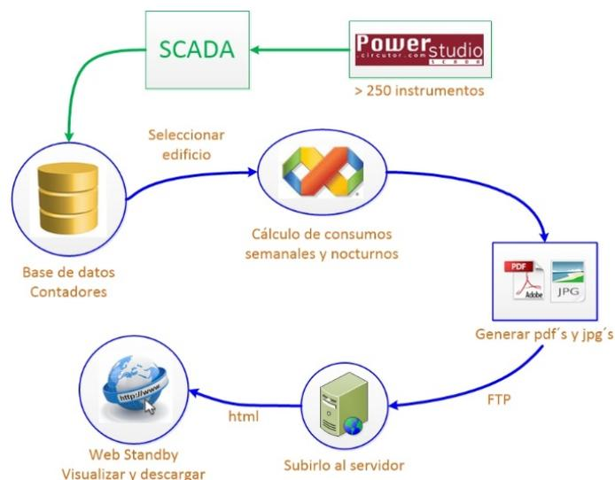
Figura 5.1: Diagrama de flujo de los datos y proceso seguido para su generación y muestra.
