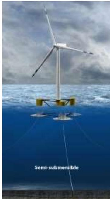
Figura 28: Estructura semi-sumergible (Fuente: [www.energy.gov](http://www.energy.gov))
