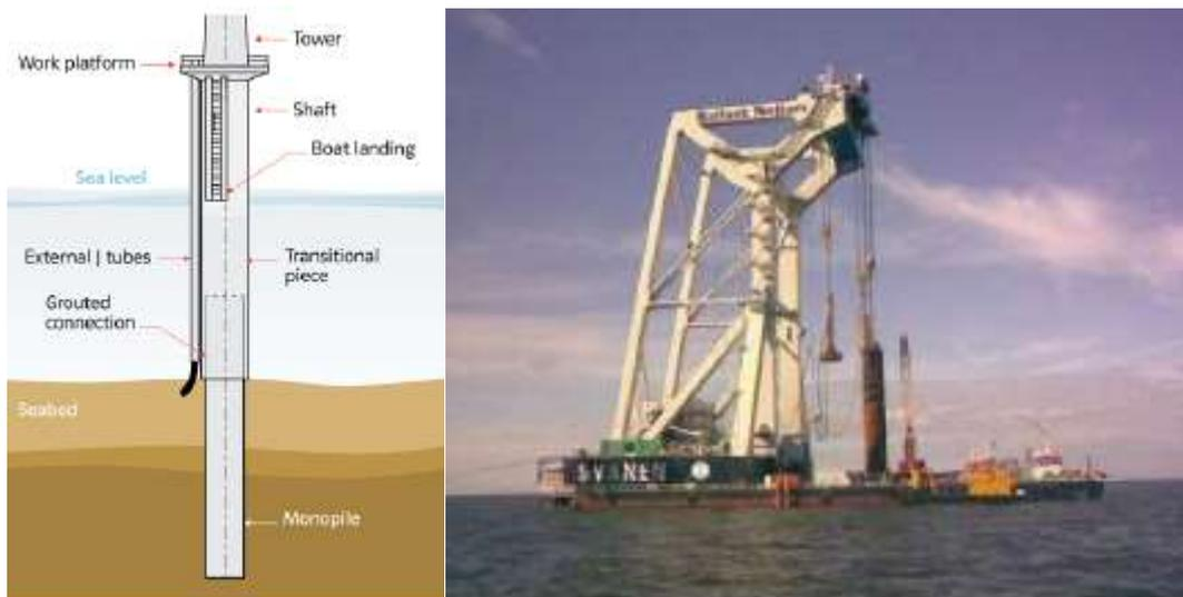
Figura 22: Cimentación y transporte de micropilote (Fuentes: [www.eon-uk.com](http://www.eon-uk.com) y Arco. et al, 2013)
