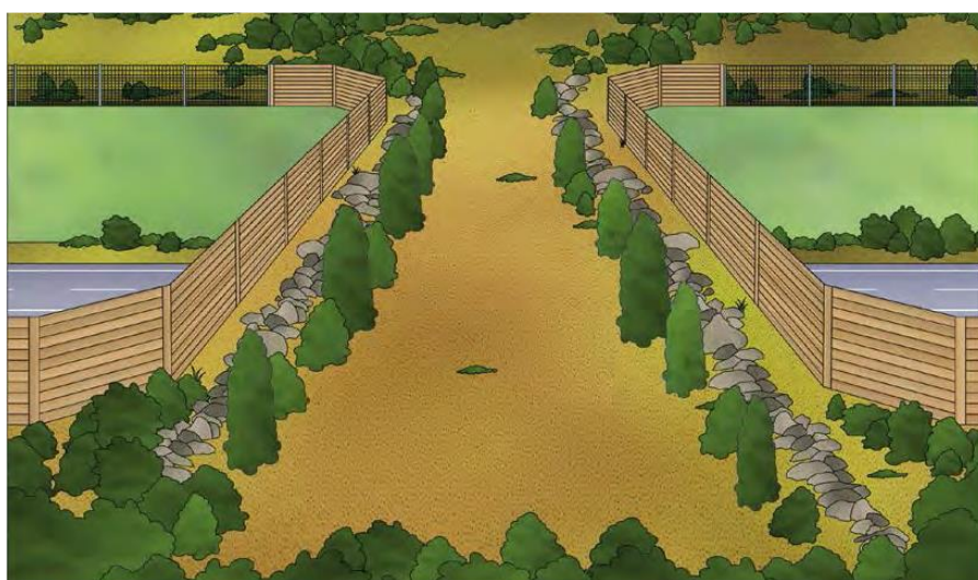
Figura 25.- Apantallamientos opacos en los márgenes laterales de un paso de fauna, incluyendo vallas de madera, muretes de piedra y plantaciones de arbustos (fuente: MAGRAMA 2015).
