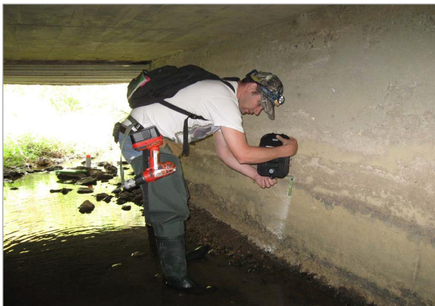
Figura 112.- Colocación de una cámara fotográfica automática en un drenaje para el estudio de su utilización como paso de fauna (fuente: SPARKS y GATES 2011).
