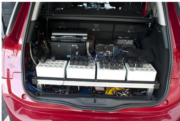
Figura 104.- Terminal de sensores y central de datos del Citroen C4 Picasso autónomo desarrollado en la factoría de Vigo (fuente: PSA Citroen).
