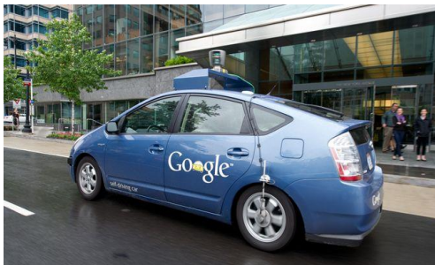
Figura 97.- Modelo del primer vehículo sin conductor de Google, montado sobre un Toyota Prius (fuente: GOOGLE 2014).
