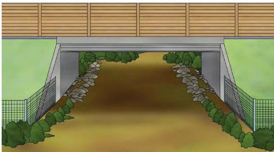
Figura 38.- Esquema general de un paso inferior específico de fauna (fuente: MAGRAMA 2006).
