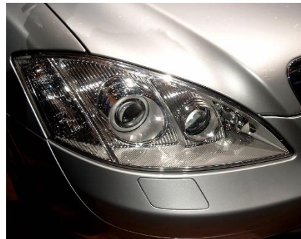
Figura 92.- Proyector de infrarrojos junto al faro principal en el Mercedes-Benz S-Class W221.
