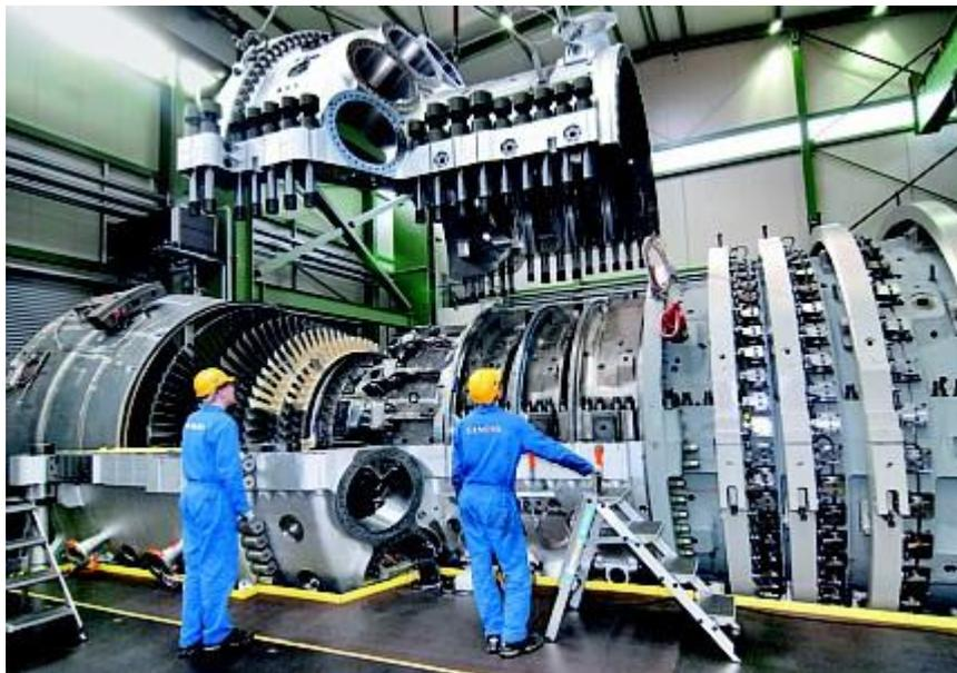
Imagen 8: Estator extraído en una Turbina de Gas.
