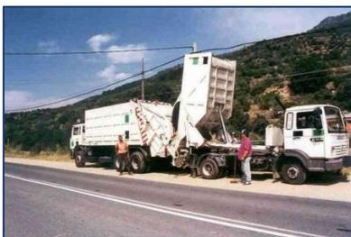
Ilustración 5. Camión satélite recolector de residuos municipales descargando sobre nodriza
