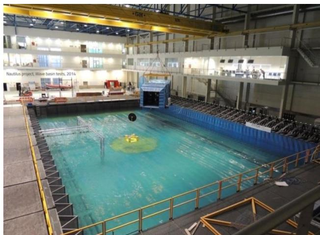
**Ilustración 20. Gran Tanque de Oleaje del IHCantabria**
