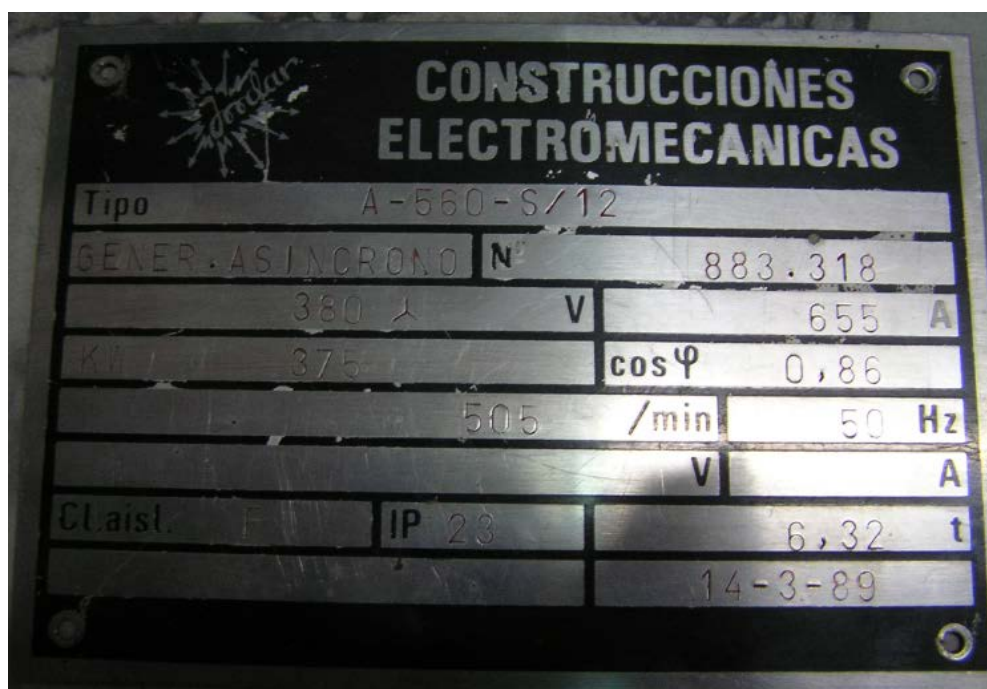
Figura 9. Placa de características del generador
