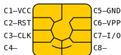
Figura 10. Contactos del chip de una tarjeta inteligente
