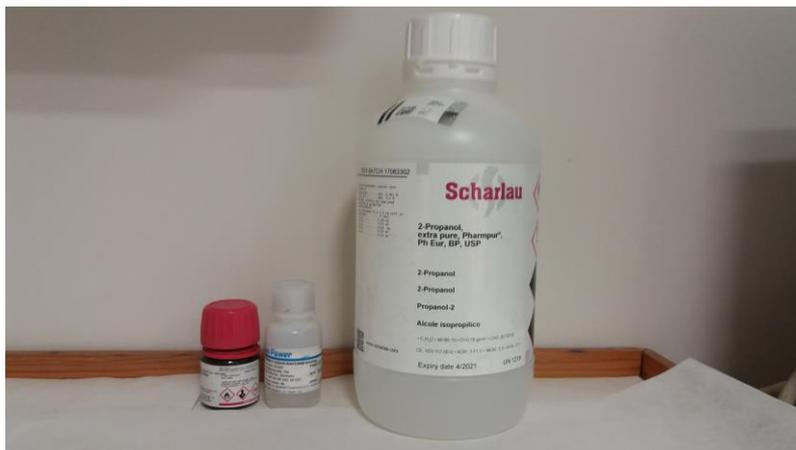
**Figura 16: Componentes de la tinta catalítica. De izquierda a derecha, platino sobre carbono grafitizado, disolución de Nafion e isopropanol**
