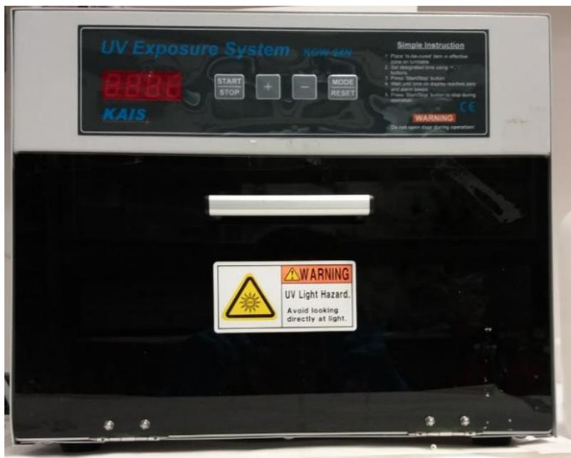
Figura 21: Equipo usado para realizar la fotopolimerización. KAIS
