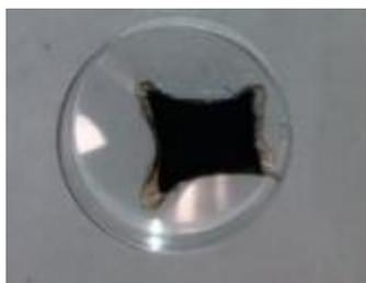
**Figura 26: Membrana de líquido iónico con catalizador depositado**
