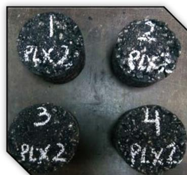
Ilustración 8. Probetas compactadas tipo Marshall
