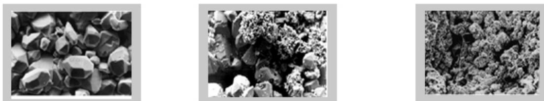
**Fig. 0.2** Fotografías de placas con distintos grados de sulfatación
