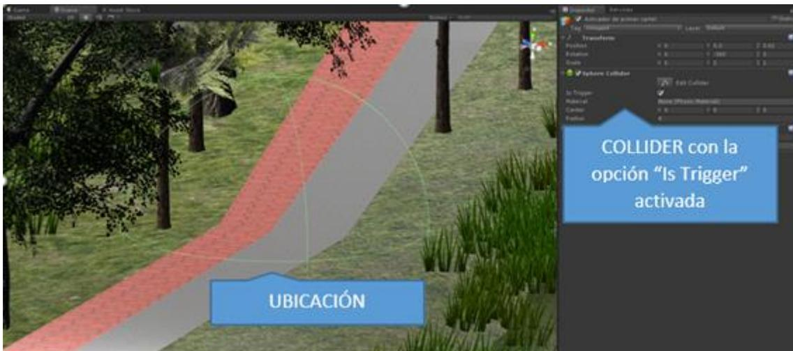
Figura 21. Empty Game Object al que se le ha añadido un componente collider esférico.
